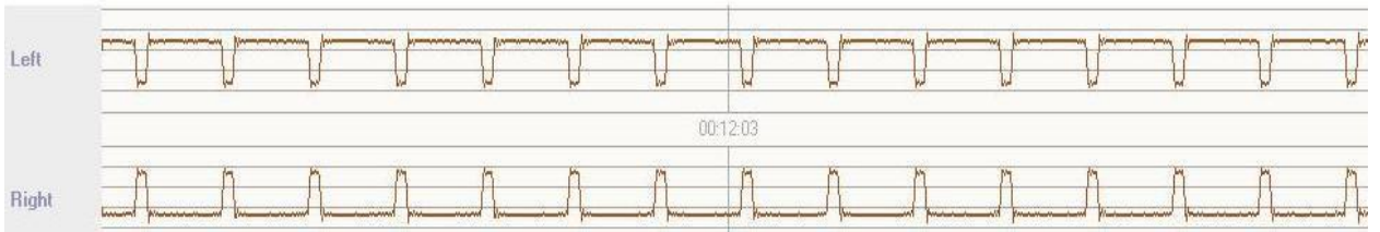
S-2. Сигнал E1 на выходе файлового плеера, в виде net-book Asus-EeePC с аудио-проигрывателем AIMP и внешней звуковой картой Creative.
