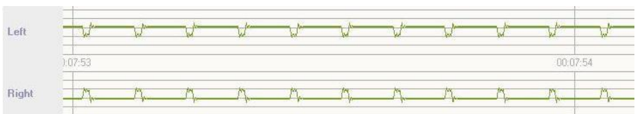
S-6. Сигнал E1 на выходе файлового плеера, в виде планшета Samsung SM-T231 с встроенной программой "Музыка".
