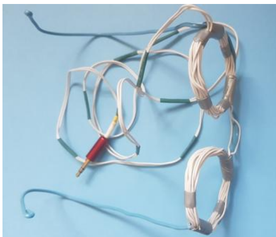
Рис.2. Индуктор в виде очков. Для лечения глаз.
