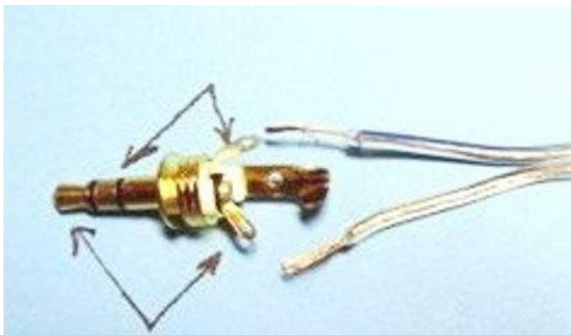
Рис.1. Контакты катушки присоединяются к правому и левому контактам штекера. Средний контакт не используется.
