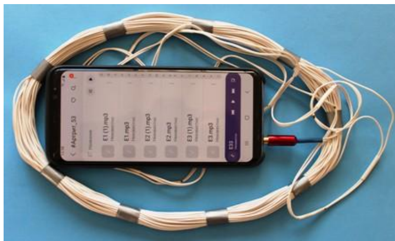
Рис.6. Файловый генератор: индуктор и смартфон-плеер .
