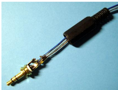
Рис. 2. Разобранный штекер с припаянными контактами.
