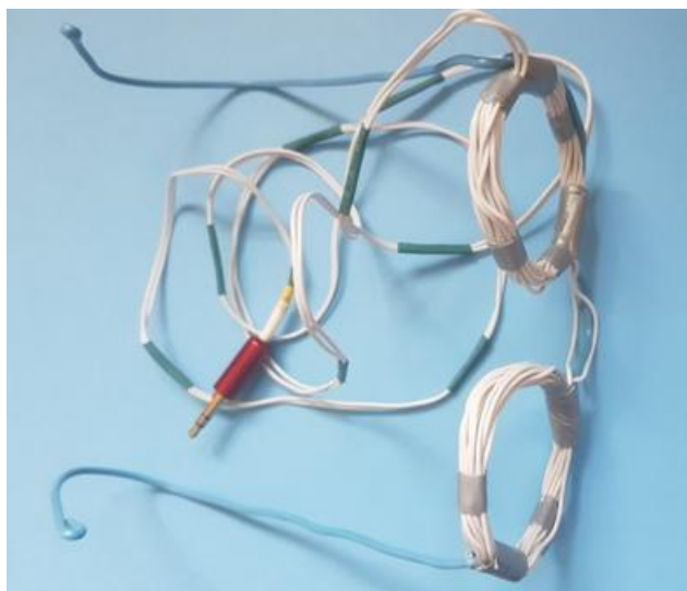
Рис.3. Индуктор в виде очков. Для лечения глаз.
