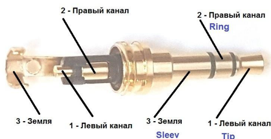
Рис.3. Разъём TRS (Tip-Ring-Sleeve), он же mini-jack.
