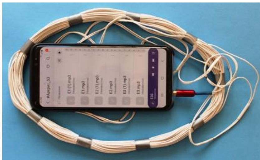
Рис.4. Файловый генератор: индуктор и смартфон-аудиоплеер.
