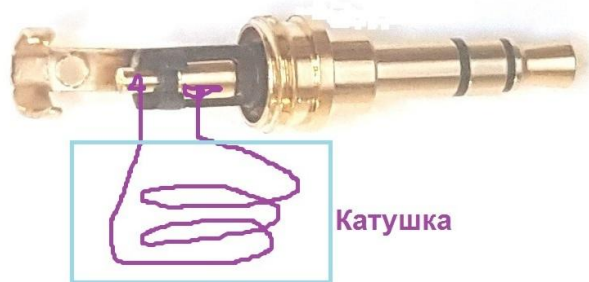
Рис.4. Антифазный индуктор . Присоединение катушки к разъёму TRS.
